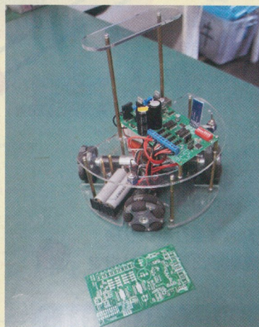
● 智能車上的電路版由小學生自行設計及製作。
